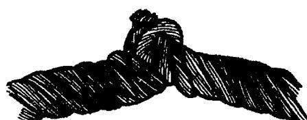
Рисунок 15. Переизвививание каната
