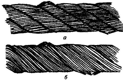
Рисунок 2. Сочетание обрывов проволок с их износом:
