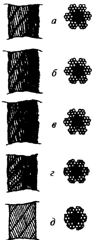
Рисунок 5. Износ наружных проволок каната крестовой свивки:
