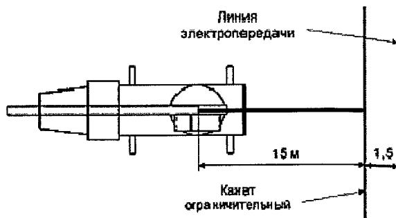
Ограничитель или указатель опасного приближения к ЛЭП считается работоспособным, если срабатывание происходит при выдвижении или наклоне стрелы крана до соприкосновения ее оголовка с ограничительным канатом.
