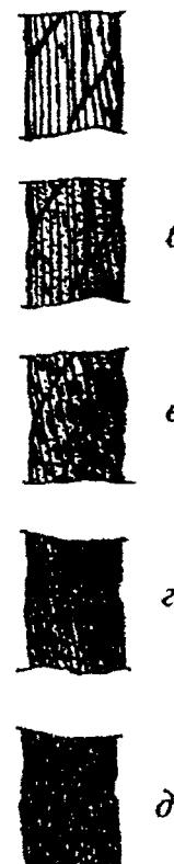
Рисунок 6. Поверхностная коррозия проволок каната крестовой свивки:
