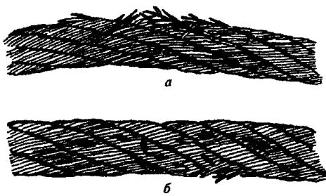
Рисунок 3. Обрывы проволок в зоне уравнительного блока:
