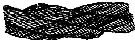
Рисунок 1. Обрывы и смещения проволок каната
