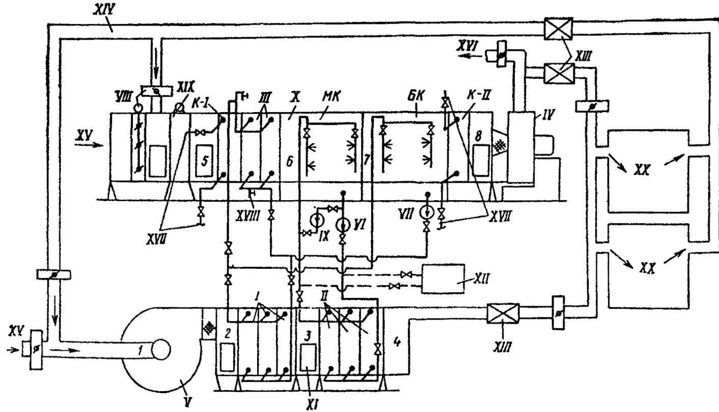
**Рис. 1. Рабочая схема двухступенчатой бескомпрессорной системы кондиционирования воздуха**
