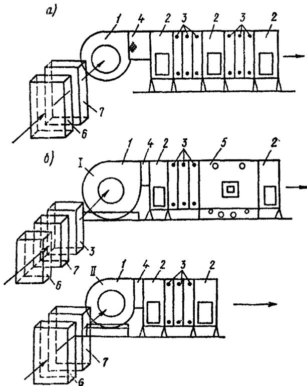
**Рис. 5. Типовые компоновки приточных кондиционеров**
