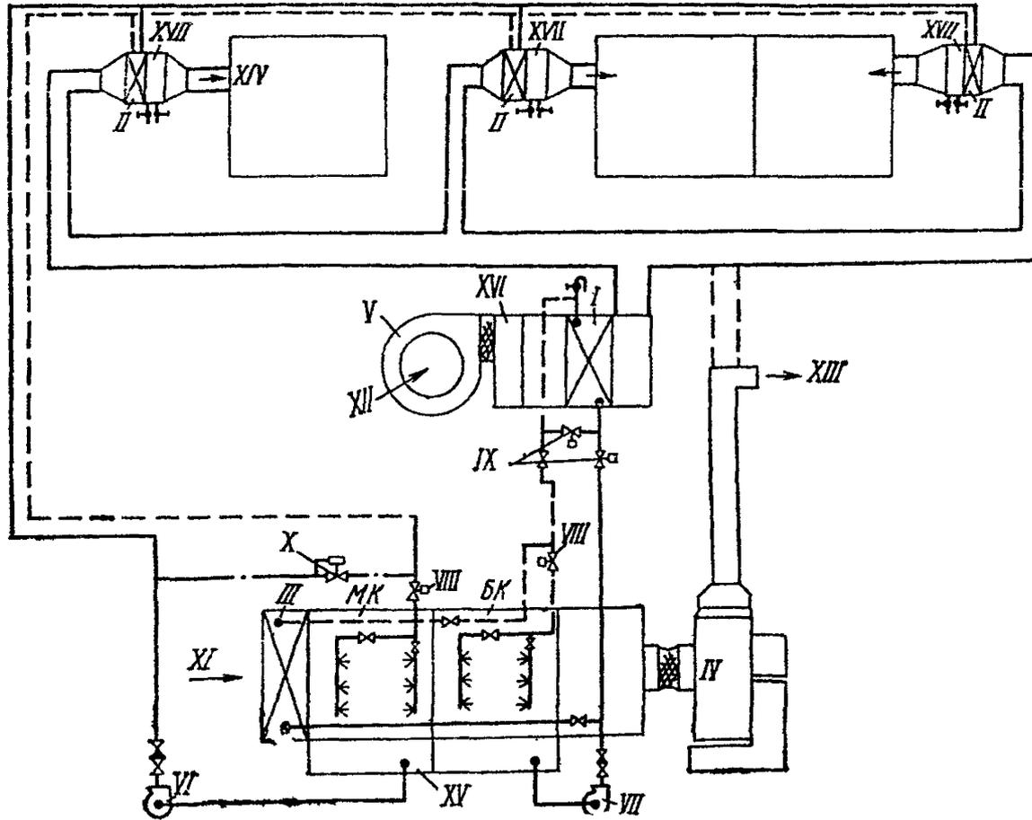
Рис. 2. Рабочая схема бескомпрессорной системы кондиционирования воздуха при обслуживании разнохарактерных помещений
