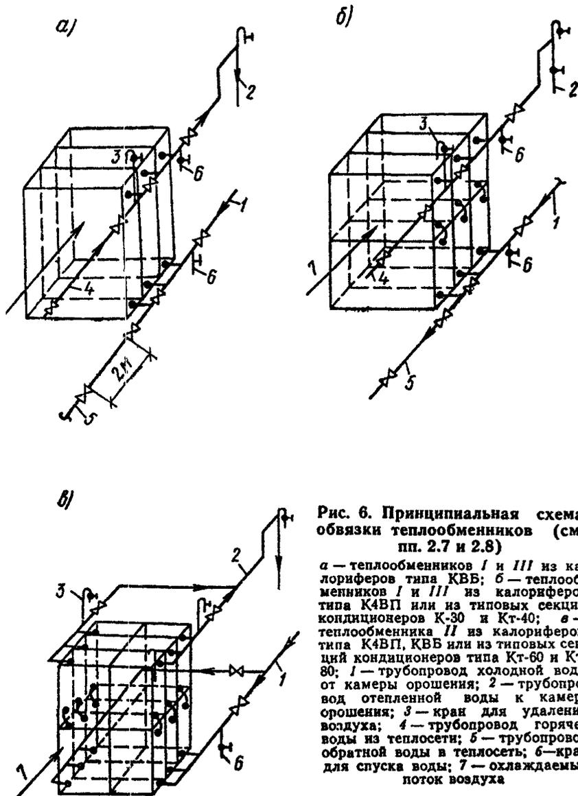
Рис. 6. Принципиальная схема обвязки теплообменников (см. пп. 2.7 и 2.8)
