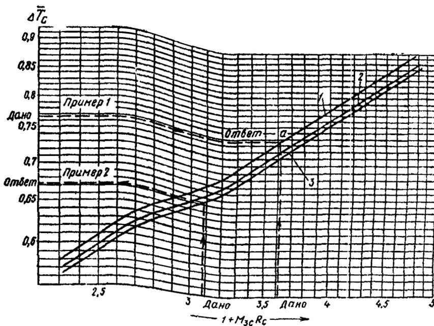
**Рис. 10.** График для определения величины охлаждения воздуха  $\Delta T_c$  в бескомпрессорных системах кондиционирования воздуха
