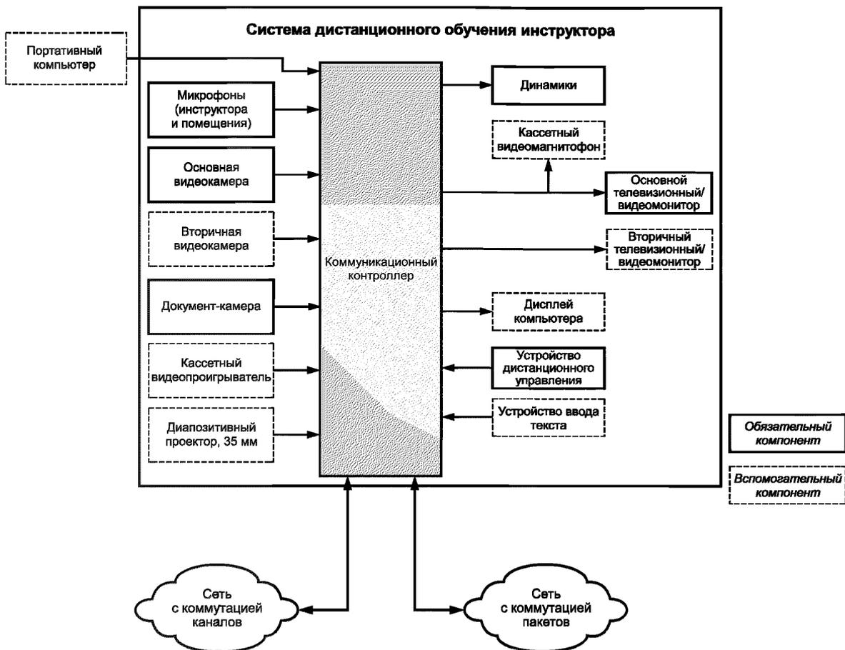
Рисунок 8 — Содержательная схема системы дистанционного обучения инструктора
