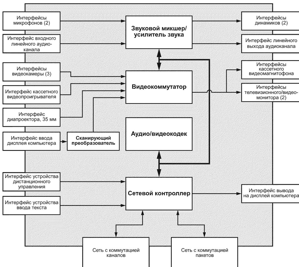
Рисунок 9 — Содержание коммуникационного контроллера системы инструктора
