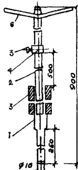
Рис. 1. Ударник удлиненный для определения плотности грунтов методом зондирования
