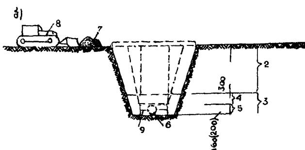
**Рис. 6.2. Схема организации работ по засыпке траншей:**
