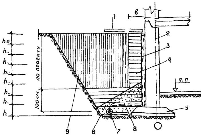
**Рис. 8.1. Схема обратной засыпки пазухи котлована:**
