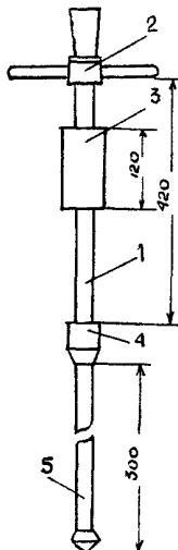
Рис.1. Прибор ДПУ для контроля плотности грунта
