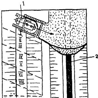
Рис. 6.4. Вариант обратной засыпки траншеи грунтом при помощи бульдозера:
