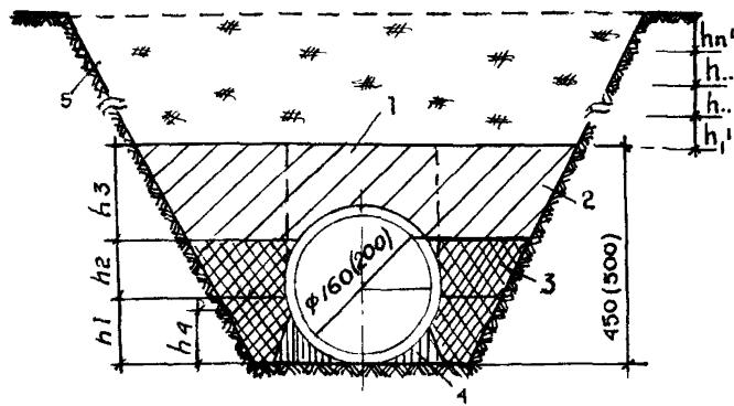
**Рис. 6.1. Схема уплотнения грунта при засыпке траншей:**
