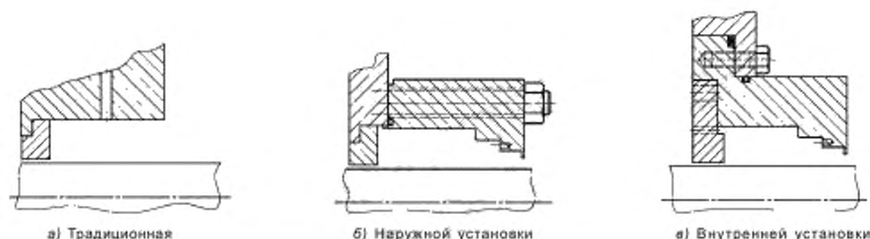
Рисунок 12 — Типы камер уплотнения
