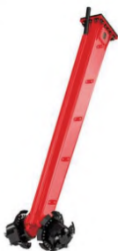
Рисунок 10 – Пример компонентов оборудования для глубинного смешивания в массиве: смеситель (а); питатель (б); система управления и регистрации основных технологических параметров (в)
