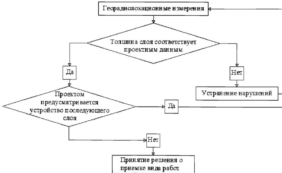
Рисунок А.1 – Алгоритм выполнения георадиолокационного операционного контроля
