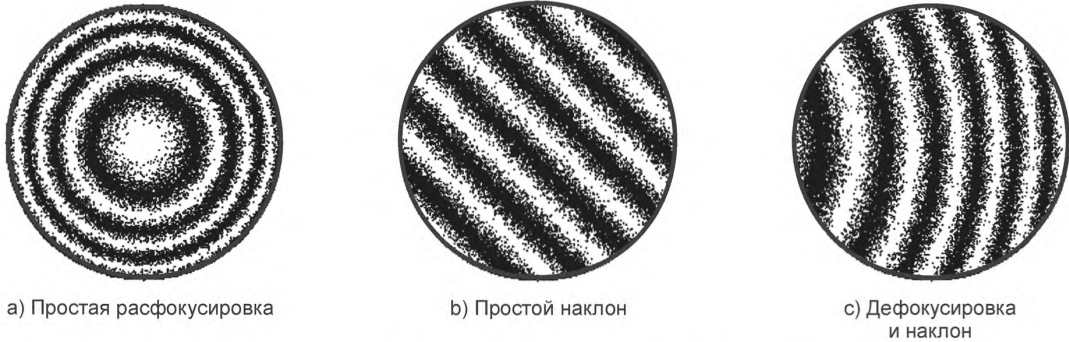
Рисунок 7 — Интерферограммы испытуемых объектов без заметных аббераций
