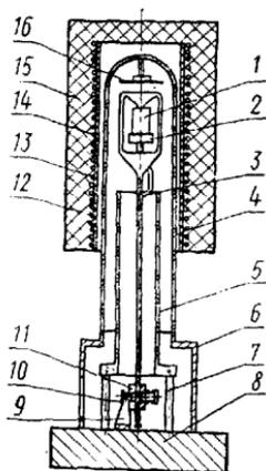
Рис. 1. Схема дилатометра системы Стрелкова П. Г.
