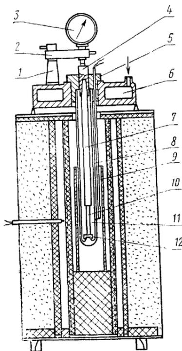
Рис. 2. Схема дилатометра ДКВ
