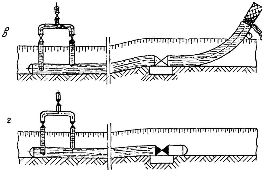
Рис. I. Принципиальная схема производства работ при промывке трубопроводов:
