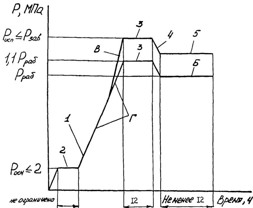
Рис.12. График изменения давления в трубопроводе при комбинированном испытании:
