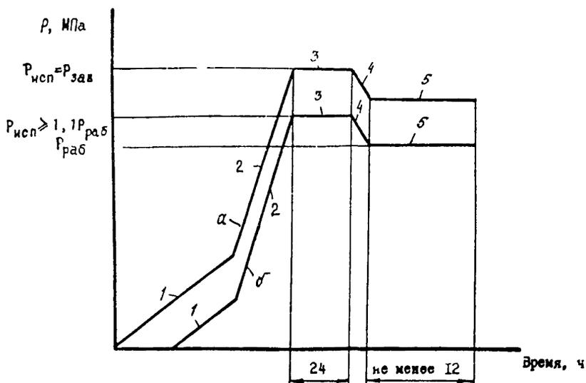
Рис.10. График изменения давления при гидравлическом испытании магистральных нефтепроводов и нефтепродуктопроводов: 1 - заполнение трубопровода водой; 2 - подъем давления до  $P_{исп}$  (а - в нижней точке трубопровода  $P_{исп} = P_{зав}$ ; б - в верхней точке трубопровода  $P_{исп} \geq 1,1 P_{раб}$ ); 3 - испытание на прочность; 4 - снижение давления; 5 - проверка на прочность
