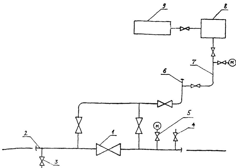
Рис. I. Принципиальная схема предварительного гидравлического испытания кранового узла:
