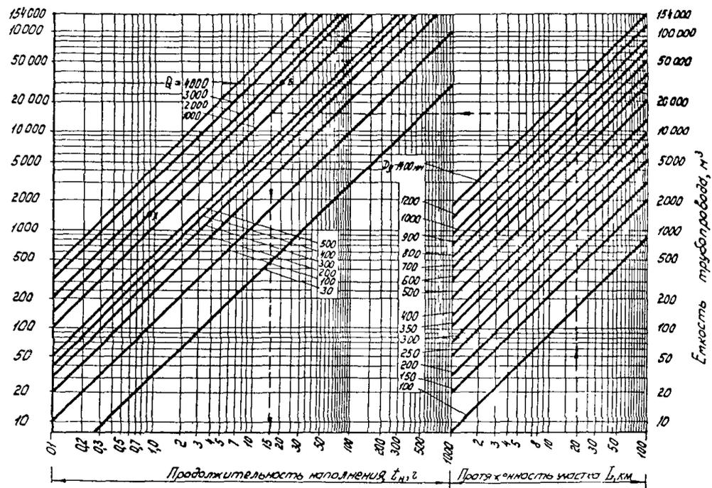
Рис. I. Номограмма для расчета времени наполнения трубопровода водой или воздухом
