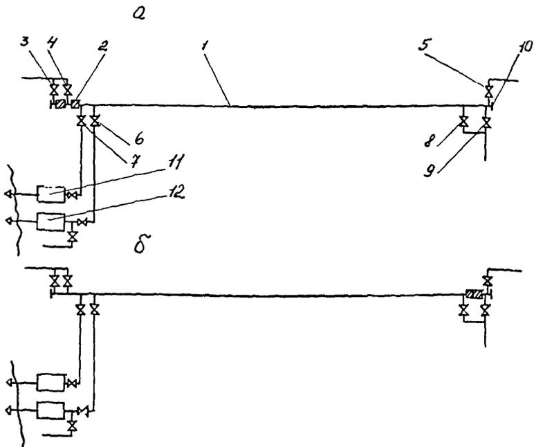
Рис.13. Принципиальная схема испытания водой подземного трубопровода без теплоизоляции при отрицательной температуре грунта:
