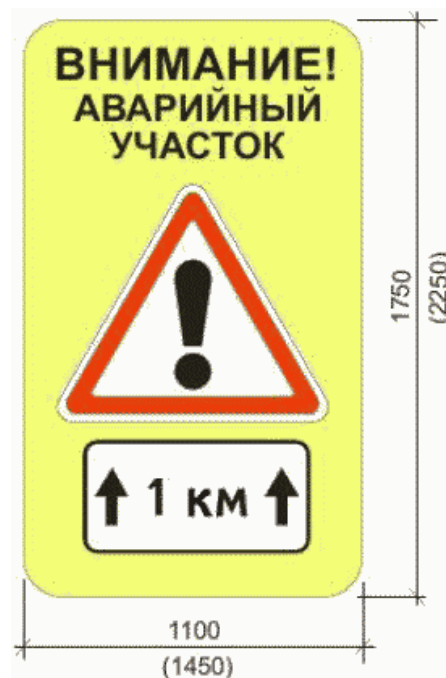
Рисунок 1 - Применение щитов из световозвращающей флуоресцентной пленки: а - пример размещения изображения предупреждающих и запрещающих знаков на щитах; б - специальные предупреждающие щиты
