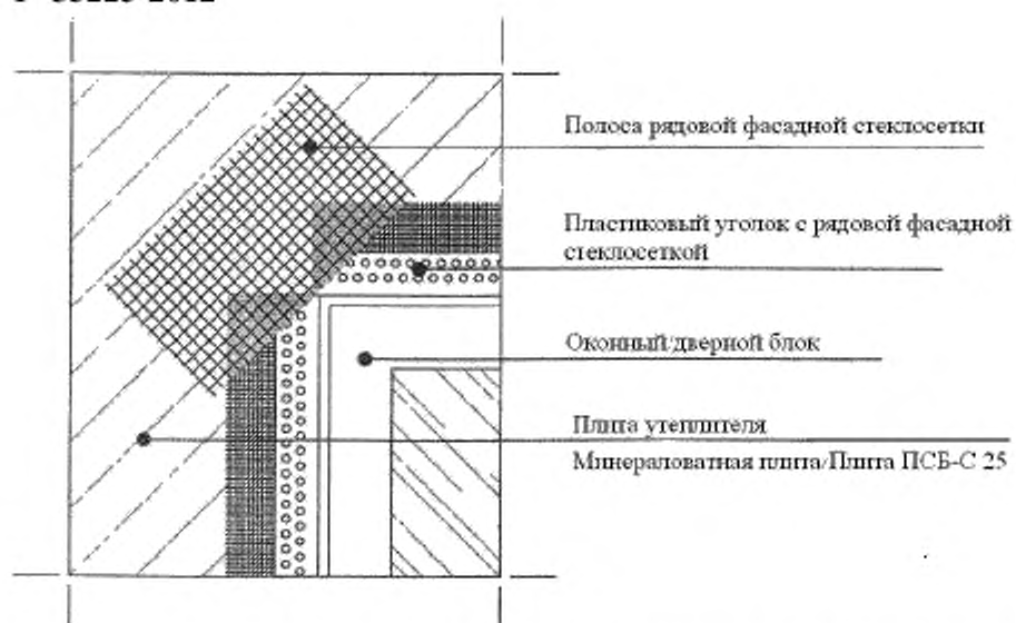
Рисунок Б.1 – Предварительное армирование оконных и дверных проемов
