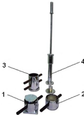
Рисунок 3 – Общий вид ручного уплотнителя Маршалла ручной с комплектом форм: 1 – деревянная стойка, 2 – подставка под форму, 3 – форма с насадкой, 4 – уплотняющий штамп со штангой и грузом
