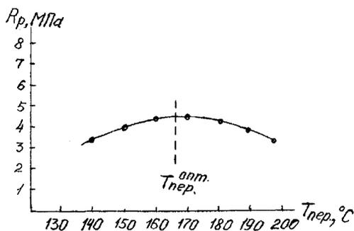
Рисунок 2 – Определение оптимальной температуры перемешивания асфальтобетонной смеси по зависимости прочности на растяжение при расколе  $R_p$  от температуры перемешивания  $T_{пер}$
