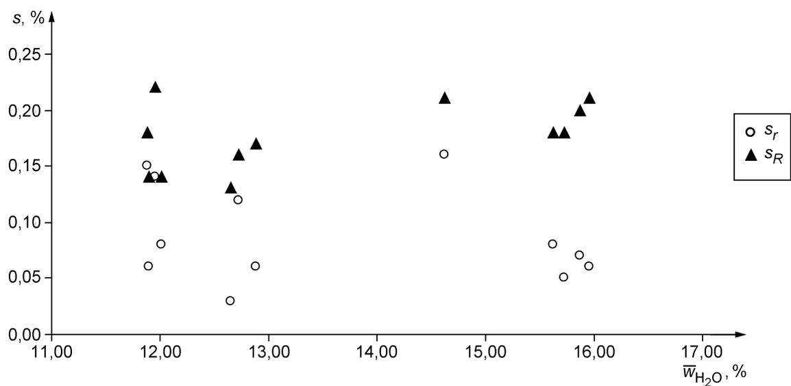
$s$  — стандартное отклонение;  $s_r$  — стандартное отклонение повторяемости;  $s_R$  — стандартное отклонение воспроизводимости;  $\bar{w}_{H_2O}$  — среднее значение содержания влаги
