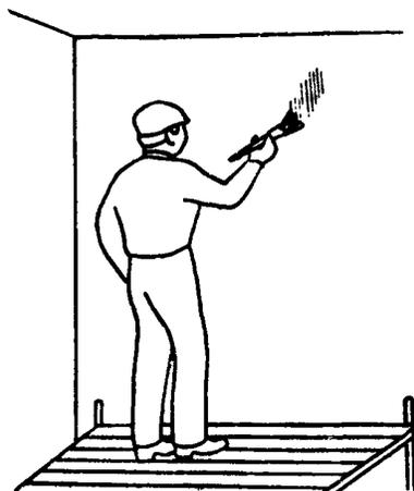
Маляр  $M_1$  со столика-подмостей, а маляр  $M_2$ , стоя на полу, производят проолифку подмазанных мест при помощи кистей-ручников
