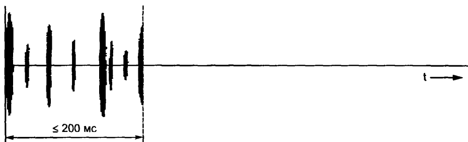
Одна кратковременная ИРП ИРП, состоящая из отдельных импульсов длительностью менее 200 мс, разнесенных интервалами менее 200 мс и продолжающаяся не более 200 мс, наблюдаемая на выходе ПЧ измерителя ИРП
