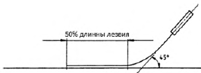
Рисунок 2 - Испытания на прочность лезвия
