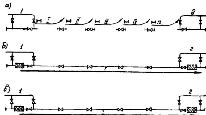
Рис.5. Принципиальная схема работ по очистке полости магистральных газопроводов в период строительства и пусконаладочных работ в три этапа:
