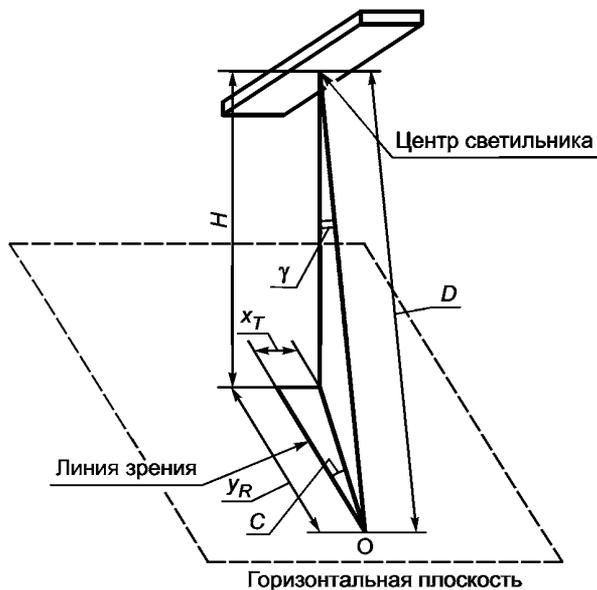
Рисунок 1 — Расположение центра светильника относительно стандартного наблюдателя по [3]
