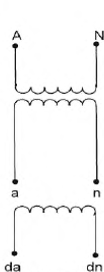
Рисунок 309 – Однофазный трансформатор с трансформатор с одной обмоткой напряжения напряжения нулевой последовательности
