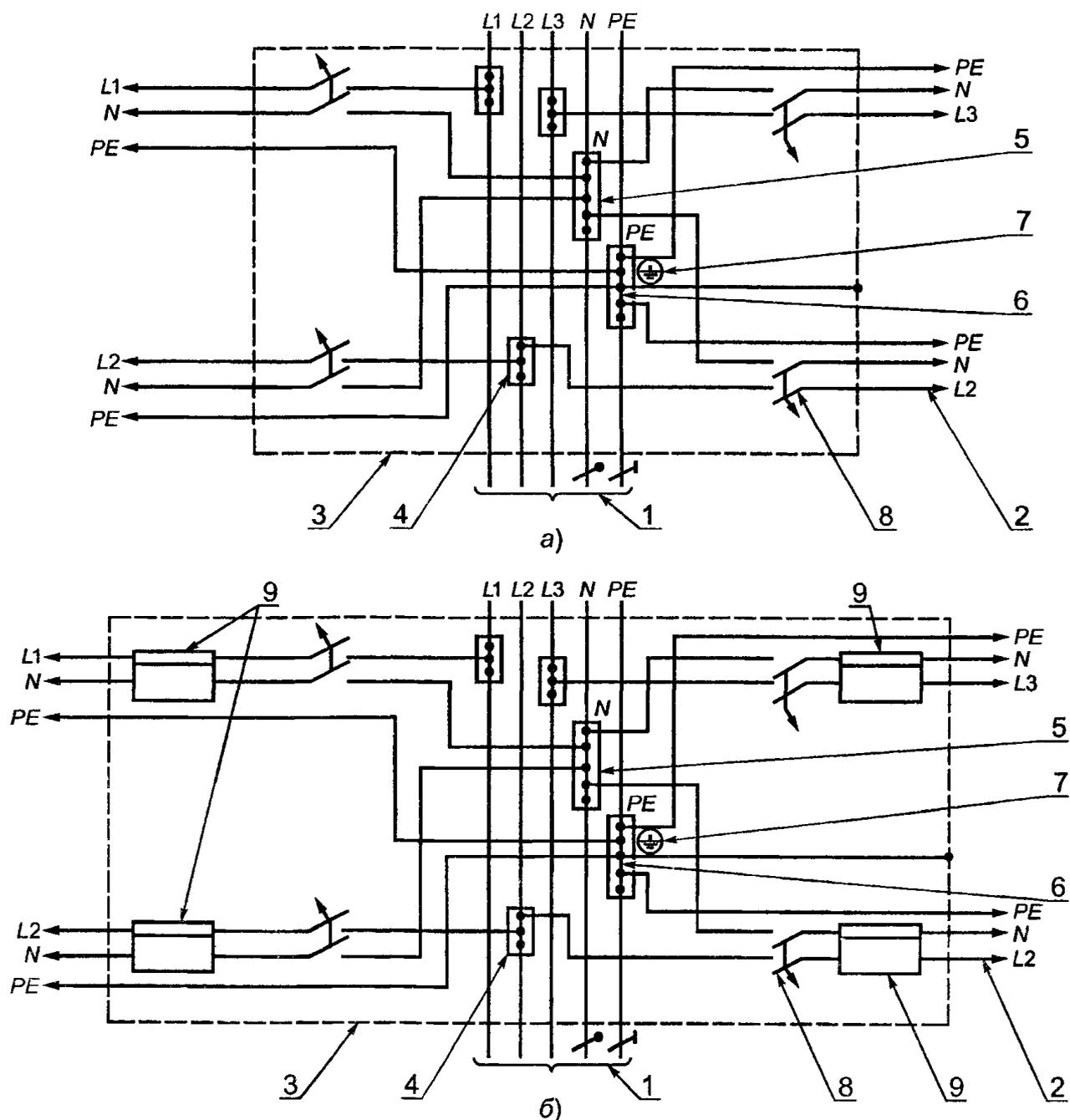
1 — питающая цепь; 2 — распределительная цепь; 3 — проводящая оболочка щитка; 4, 5, 6 — зажимы для проводников питающей цепи (фазных, нулевых защитных PE, нулевых рабочих N) и проводников распределительных цепей; 7 — знак заземления у зажимов (поз. б); 8 — автоматический выключатель; 9 — счетчик
