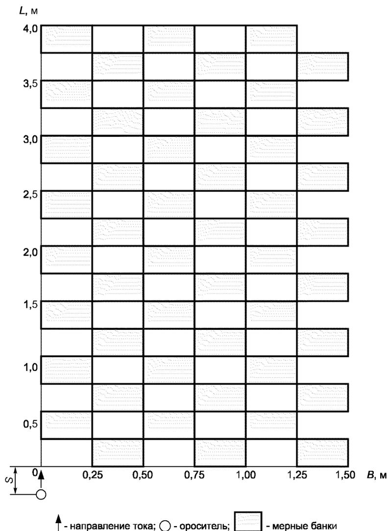
Рисунок 4 — Схема расположения мерных банок при испытании водяных оросителей типов Г, Г<sub>В</sub>, Г<sub>Н</sub> и Г<sub>У</sub>
