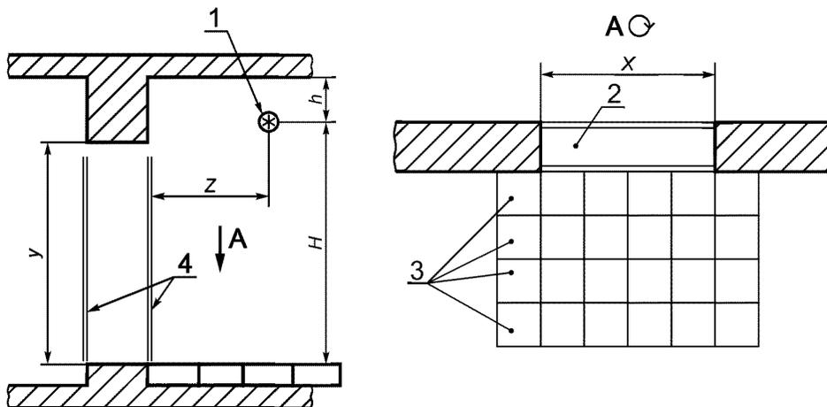
1 — ороситель; 2 — воображаемый проем; 3 — мерные банки; 4 — линии воображаемого проема;  $h$ ,  $H$ ,  $Z$  — расстояния соответственно от розетки оросителя до потолка, до нижней плоскости воображаемого проема и до стены, указанные в ТД на конкретный тип оросителя;  $X$  — ширина проема;  $Y$  — высота проема
