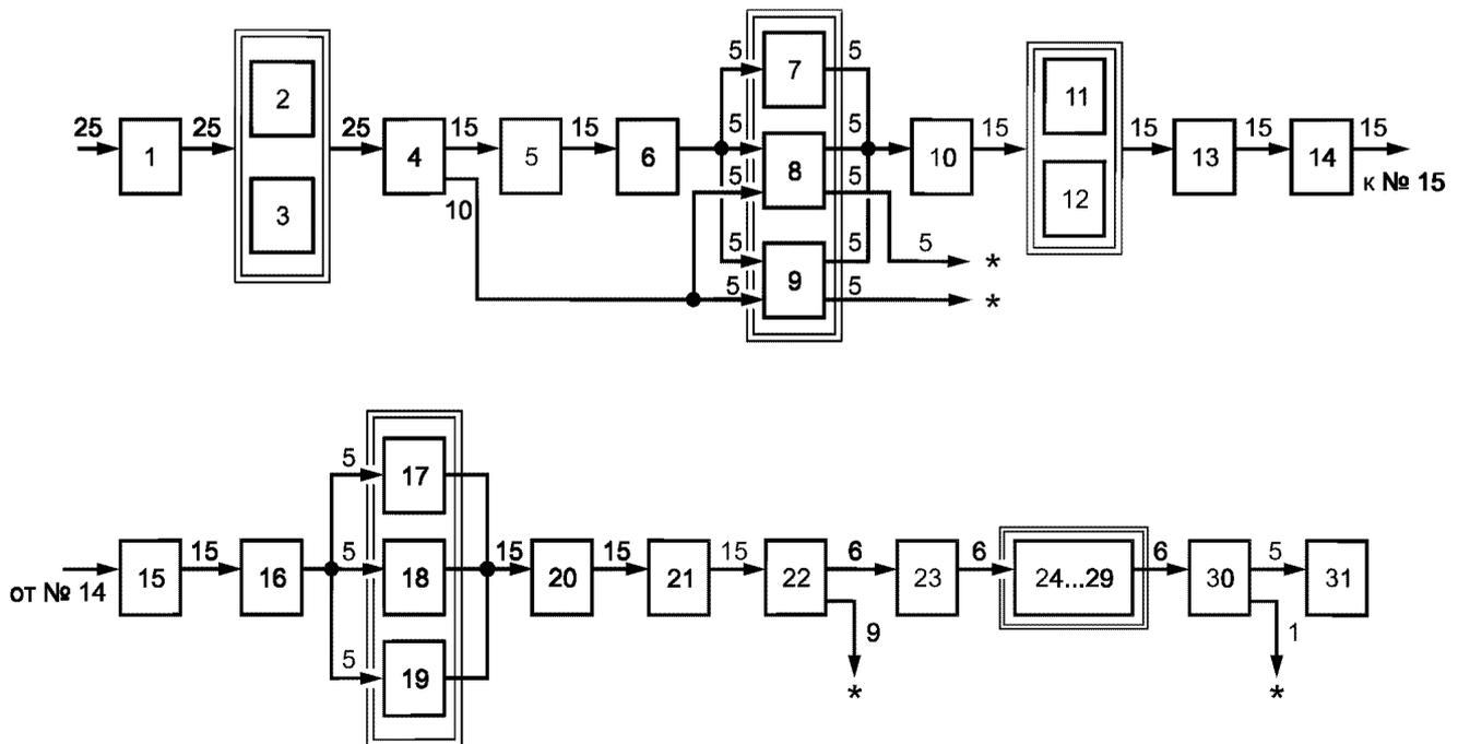
Примечание — 12 — цифра в квадрате обозначает номер испытания (пункт таблицы 5) 25 — цифра над стрелкой обозначает количество оросителей, подвергаемых данному виду испытаний; знак «\*» означает, что данные оросители далее испытаниям не подвергаются
