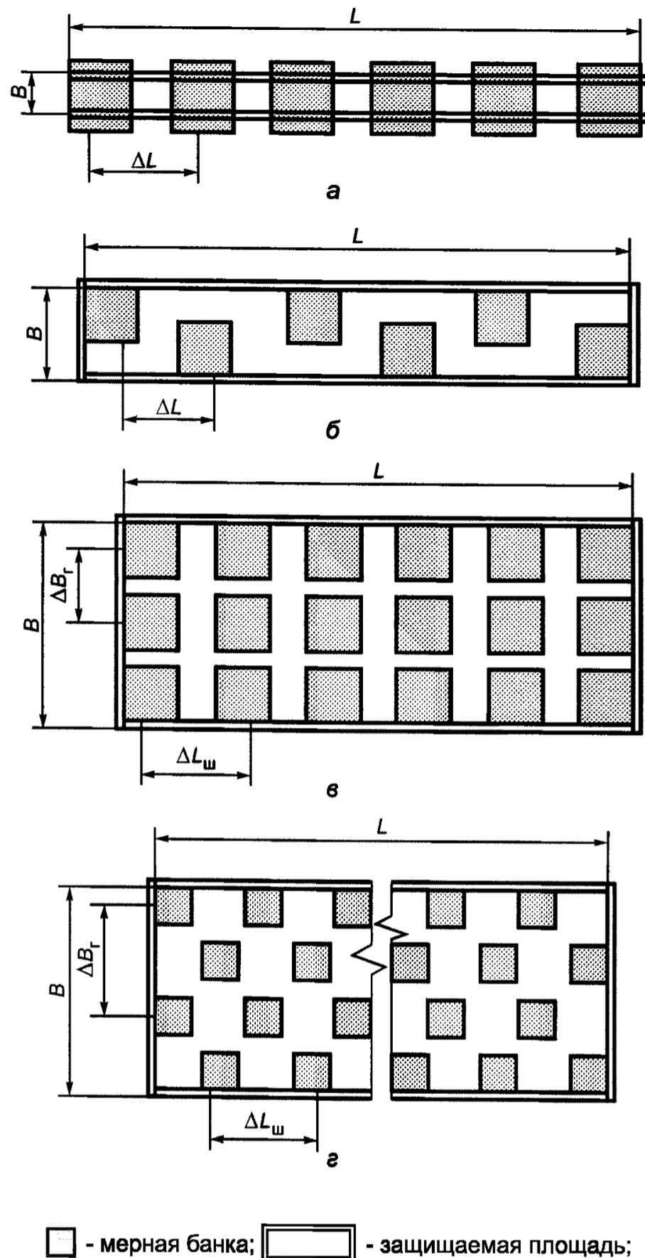
$L$  — ширина защищаемой площади;  $B$  — глубина защищаемой площади;  $\Delta L$ ,  $\Delta L_{ш}$  — межосевое расстояние между смежными мерными банками в ряду по ширине завесы;  $\Delta B_r$  — межосевое расстояние между смежными мерными банками в ряду по глубине завесы
