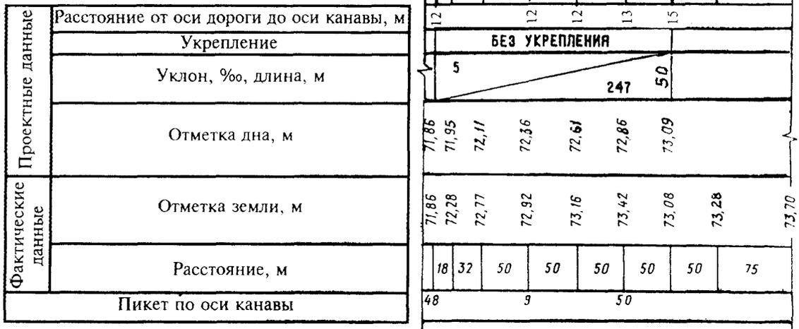
Пример оформления поперечного профиля земляного полотна автомобильной
