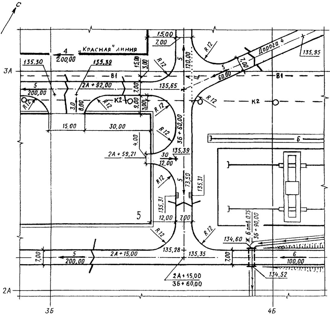
Рисунок А2 — В проектных отметках
