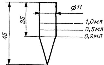
Рис. 8. Микропробирка для упаривания этилового спирта, калиброванная на 0,2; 0,5 и 1,0 мл по ГОСТ 1770-74
