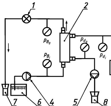
1 – регулятор давления; 2 – гемодиализатор; 3 – система подачи диализирующего раствора; 4 – перфузионный насос; 5 – источник вакуумметрического давления диализирующего раствора; 6 – резервуар испытательного раствора; 7, 8 – слив
