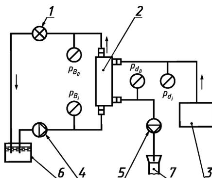
1 – регулятор давления; 2 – гемодиализатор; 3 – система подачи диализирующего раствора; 4 – перфузионный насос; 5 – источник вакуумметрического давления диализирующего раствора; 6 – резервуар испытательного раствора; 7 – слив
