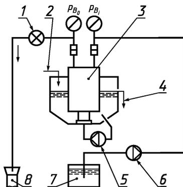
1 – регулятор давления; 2 – свежеприготовленный диализирующий раствор; 3 – гемодиализатор; 4 – переток диализирующего раствора в слив; 5 – рециркуляционный насос диализирующего раствора; 6 – перфузионный насос; 7 – резервуар для испытательного раствора; 8 – слив
