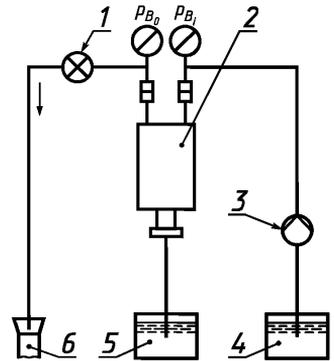
1 – регулятор давления; 2 – гемодиализатор; 3 – перфузионный насос; 4 – резервуар для испытательного раствора; 5 – фильтрат; 6 – слив
