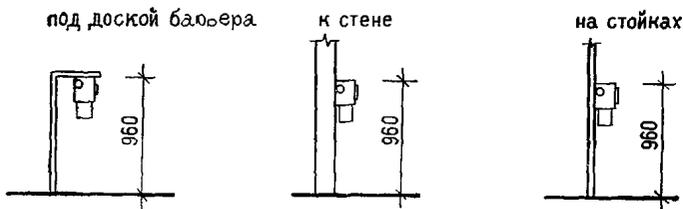
Пневмопочта предназначена для транспортировки документов с помощью движимых по трубе под напором воздуха патронов с корреспонденцией. На линии может быть несколько десятков пунктов с приемно-
