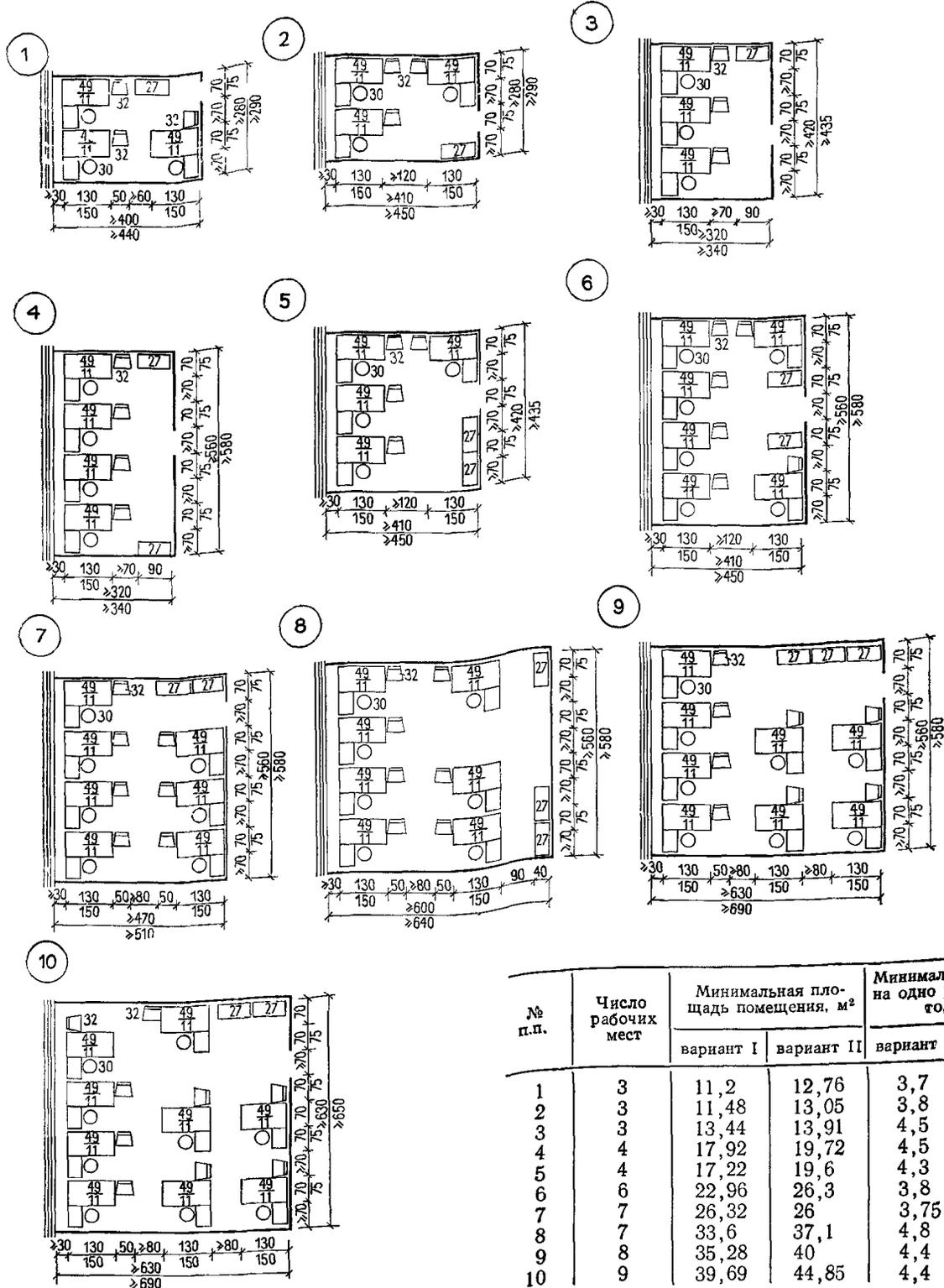
Примечания: 1. Каждая габаритная схема разработана в двух вариантах исходя из двух типов столов (малый рабочий стол 130×70 см и большой рабочий стол 150×75 см). Номера позиций над чертой относятся к типу I, под чертой — к типу II.
