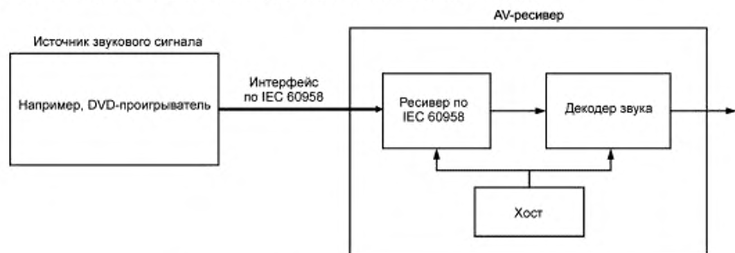
Рисунок F.1 — Модель источников звукового сигнала и AV-ресивера
