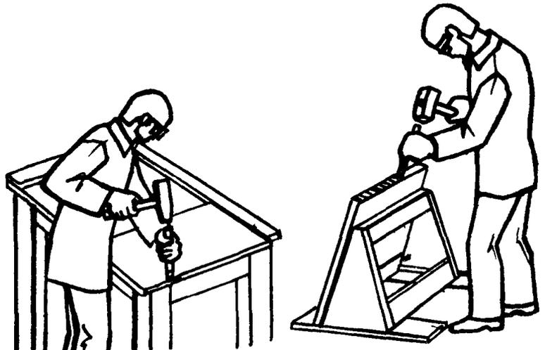
Облицовщики О<sub>1</sub> и О<sub>2</sub> на верстаках окальвают зубилами кромки плит по намеченным линиям, затем в пирамиде отесывают кромки скarpелем и укладывают обработанные плиты у верстаков
