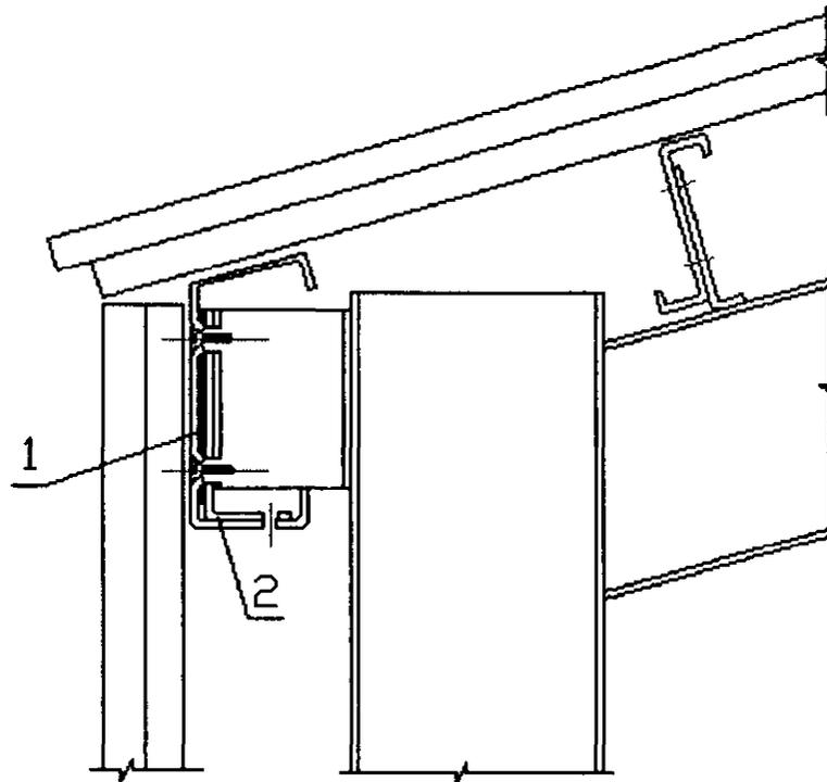
Рисунок 21- Схема крепления карнизной балки к колонне.
