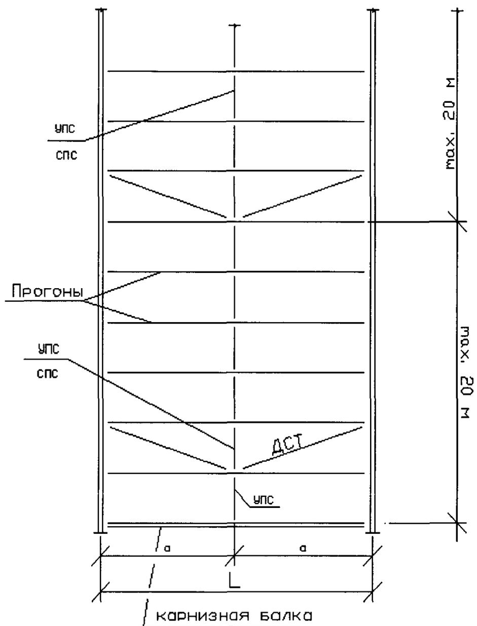
Рисунок 23 - Схема связей между прогонами покрытия с распорками в один ряд (узлы связей см. в приложении Г)
