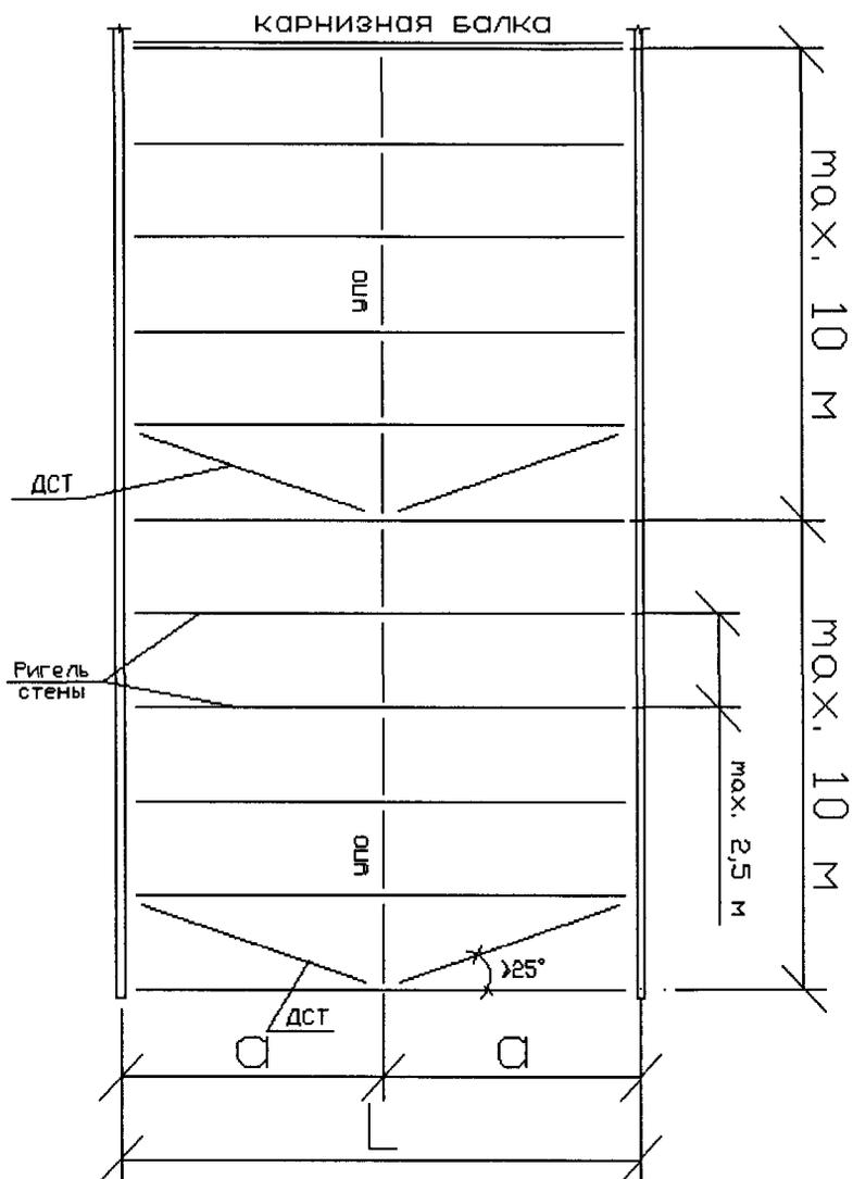
Рисунок 26—Схема связей между стеновыми ригелями пролетом от 3,2 до 6,1 м с поперечными упорами в один ряд. (узлы связей см. в приложении Г)
