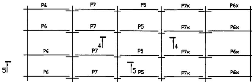
Рисунок 6-Схема расположения прогонов Z-образного сечения с муфтами на опорах и усиленными крайними пролетами
