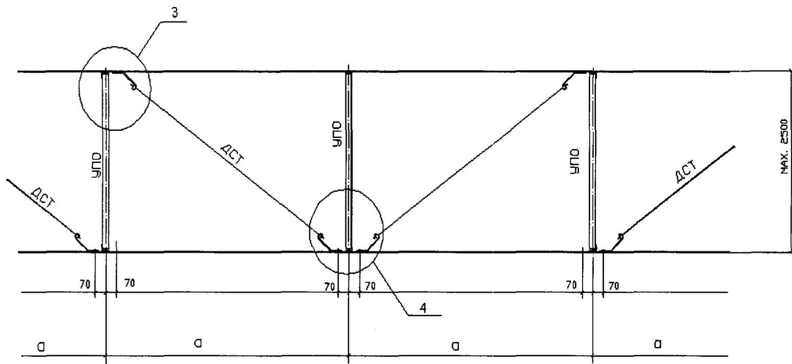
Рисунок Г.4 - Система связей ДСТ для покрытия и стен
