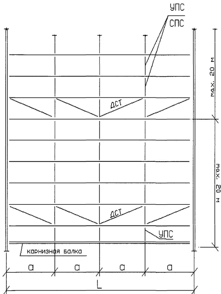
Рисунок 25 - Схема связей между прогонами покрытия с распорками в три ряда (узлы связей см. в приложении Г)
