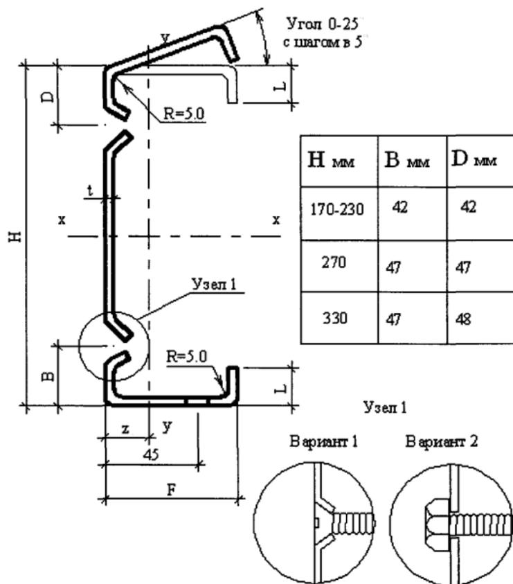
Рисунок 3-Профиль С-образного сечения с отогнутой верхней полкой
