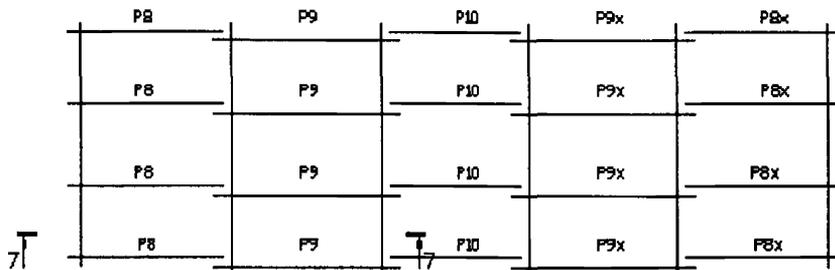
Рисунок 7-Схема расположения прогонов Z-образного сечения с соединениями внахлест на опорах
