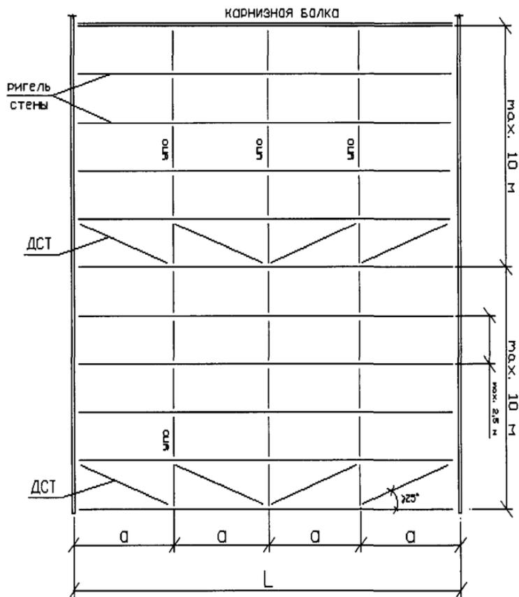
Рисунок 28—Схема связей между стеновыми ригелями пролетом от 10,1 до 12 м с поперечными упорами в три ряда. (узлы связей см. в приложении Г)
