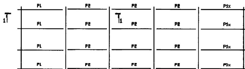
Рисунок 4-Схема расположения однопролетных прогонов Z-образного сечения
