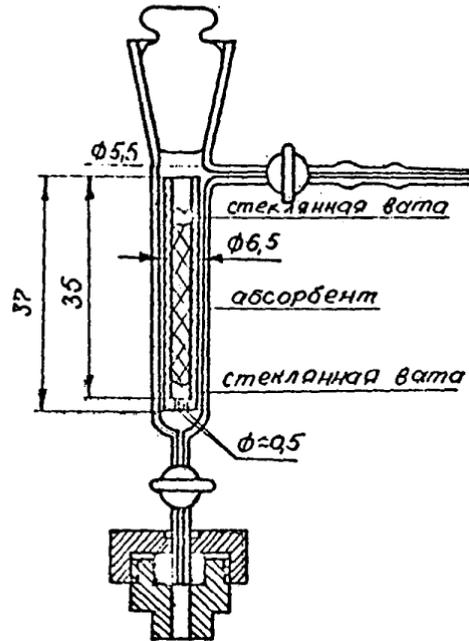
Рис.2. Устройство для ввода сконцентрированных в концентрате проб в хроматограф.
