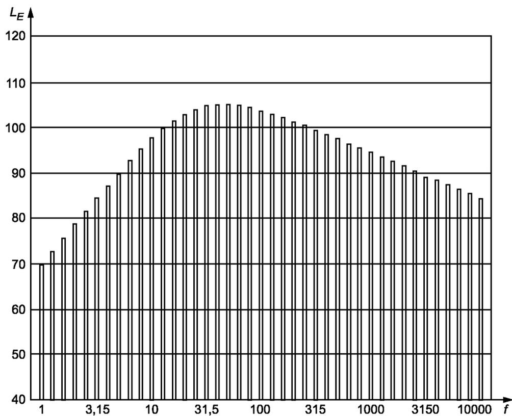
$f$  — частота, Гц;  $L_E$  — уровень звукового воздействия, дБ
