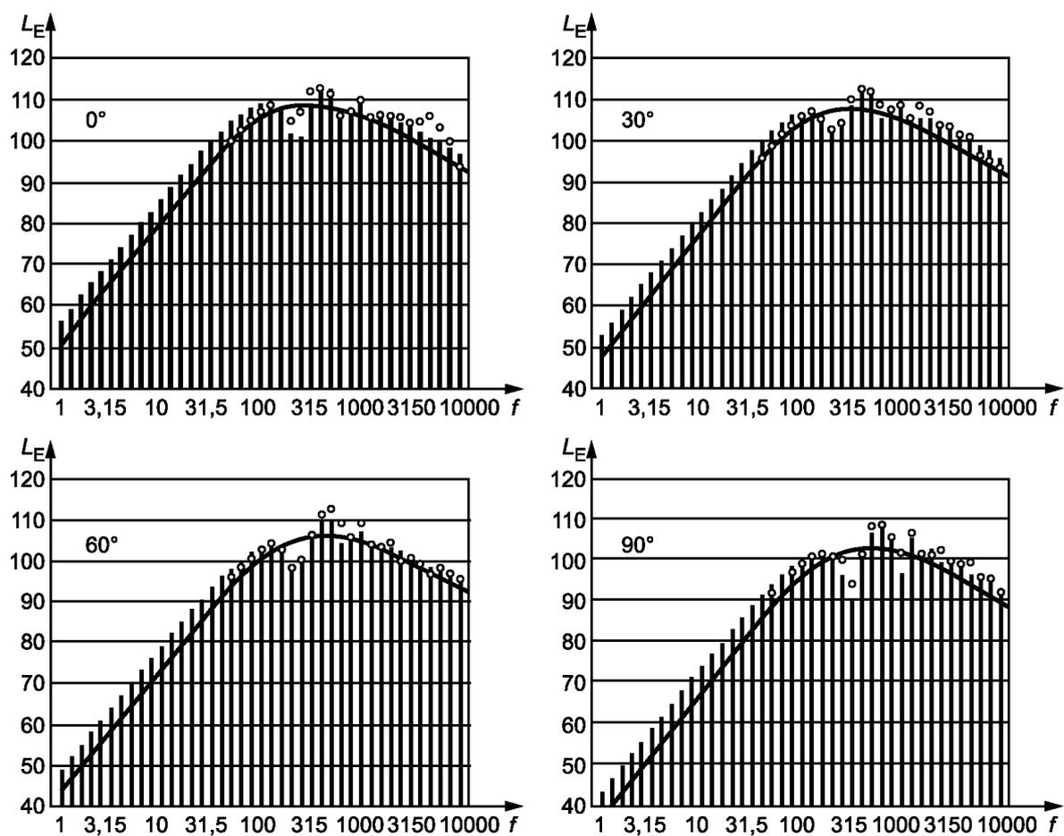
$f$  — частота, Гц;  $L_E$  — уровень звукового воздействия; ° — измеренные значения; вертикальные полосы — расчетные значения; сплошная кривая — уровень звукового воздействия в условиях свободного звукового поля
