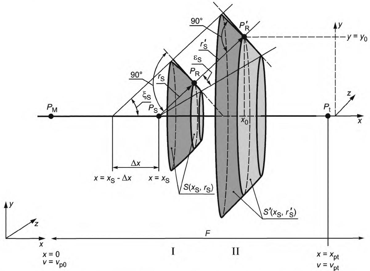
$x$  — координата вдоль линии огня;  $y$  — направление, перпендикулярное линии огня в произвольном направлении относительно нее;  $F$  — длина траектории;  $P_M$  — положение дула;  $P_t$  — положение цели или точки на траектории пули, в которой скорость пули становится дозвуковой;  $P_S$  — положение пули;  $P_R$  — точка измерения
