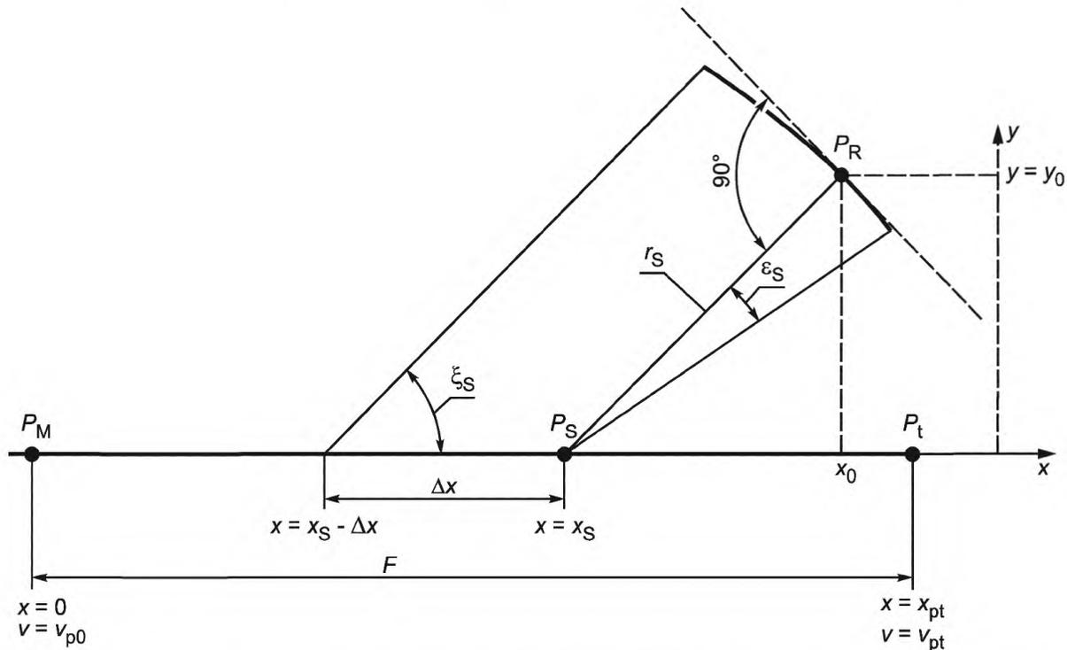
$x$  — координата вдоль линии огня;  $y$  — направление, перпендикулярное линии огня в произвольном направлении относительно нее;  $F$  — длина траектории;  $P_M$  — положение дула;  $P_t$  — положение цели или точка на траектории пули, в которой скорость пули становится дозвуковой;  $P_S$  — положение пули;  $P_R$  — точка измерения
