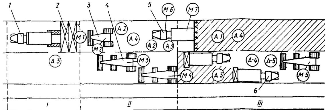
А 1—А 5 М 1—М 7 — места нахождения рабочих, 1 — завоз и распределение щебня первой фракции самоходным распределителем, II — уплотнение щебня первой фракции, III — розлив битума, распределение щебня второй фракции и его уплотнение, 1 — авто самосвал, 2 — самоходный распределитель щебня Д 337А, 3 — легкий каток, 4 — тяжелый каток, 5 — автогудронатор Д 251, 6 — автосамосвал с навесным распределителем
