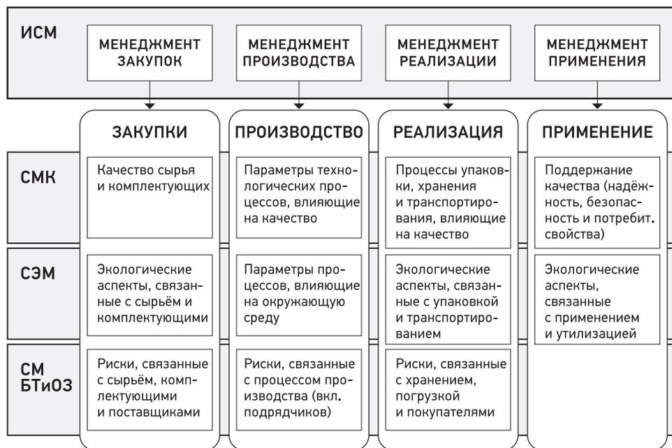
Рис. 10.2. Структура процессов жизненного цикла продукции с точки зрения ИСМ
