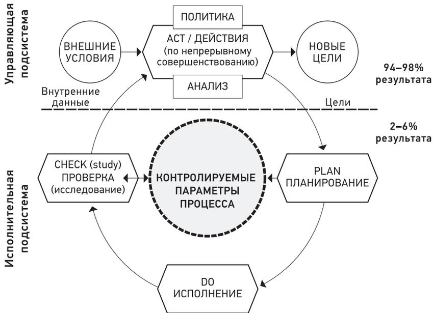
Рис. 3.3. Модифицированный цикл Деминга APDC(S)
