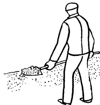
**5 РАЗРАВНИВАНИЕ И ПРИКАЛКА ГРАВИЯ; К<sub>1</sub> – 28 мин; К<sub>4</sub> – 38 мин; К<sub>5</sub> – 51 мин; гребки, каток**
