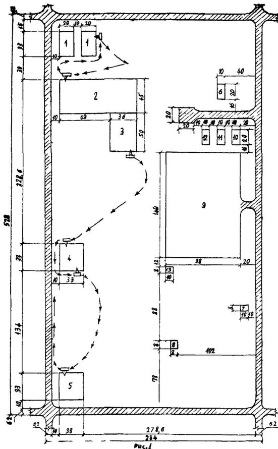
Рис.1. Примерная схема расположения оборудования и строений на трубосварочной базе (размеры даны в метрах):
