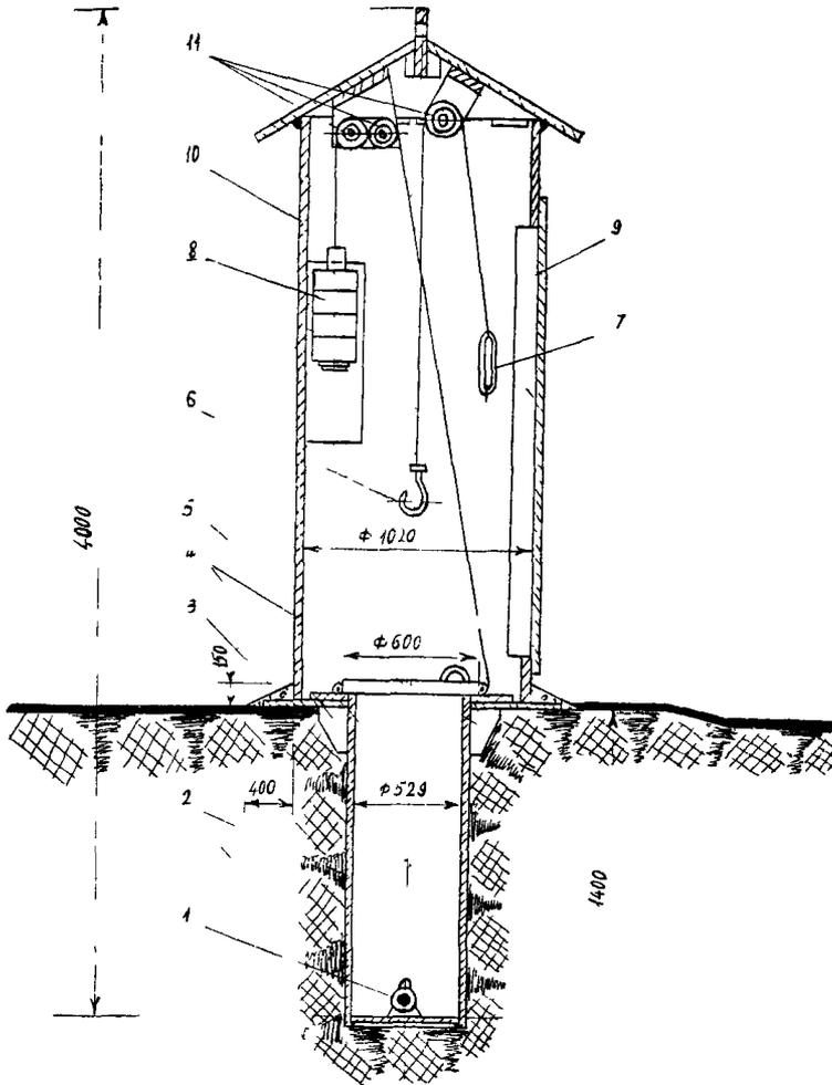
Рис. 2. Типовая схема временного хранилища для источников излучения из металлических труо (размеры даны в мм):
