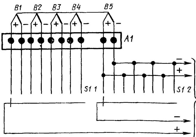
B1...B4—проверяемые чувствительные элементы; B5—термопреобразователь образцового термоэлектрического термометра, A1—термостат для свободных концов; S1—бесстремоточный переключатель.
