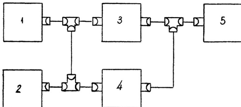
1-поверяемый измеритель; 2- вольтметр цифровой; 3-генератор импульсов; 4-аттенуатор из комплекта генератора; 5-нагрузка из комплекта генератора.
