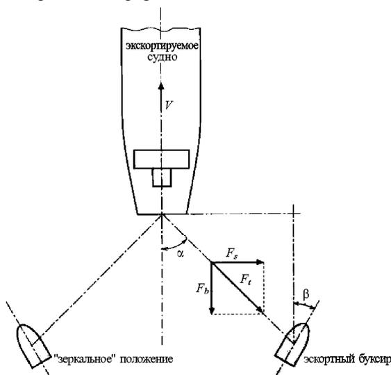
Рис. 2.1.2.1 Типовая схема эскортных операций
