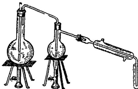
Рис. 14. Прибор для перегонки с во-
