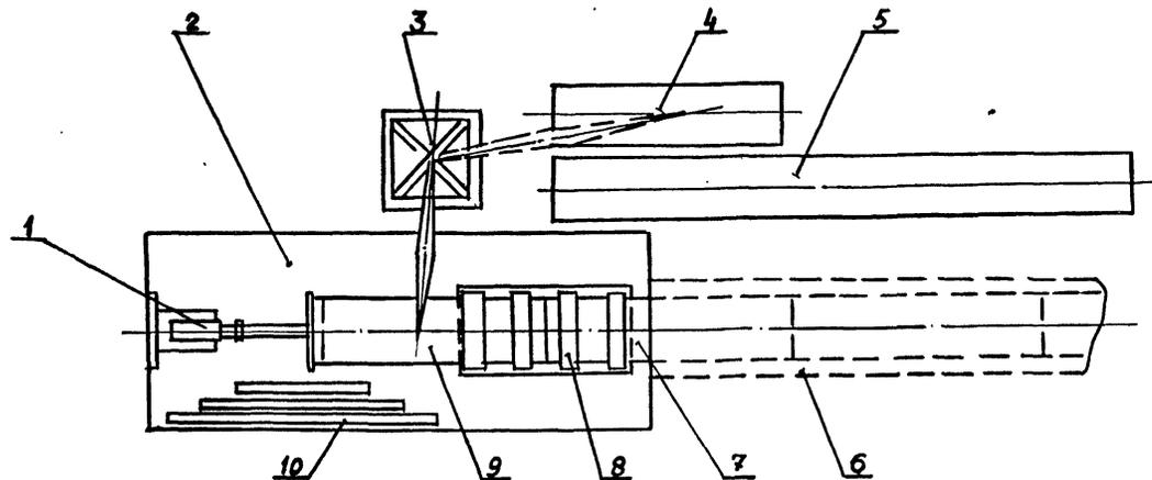
I - гидродомкрат; 2 - шахта; 3 - кран; 4 - отрезок трубы; 5 - место складирования труб;
