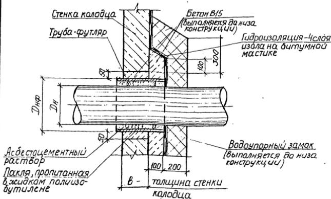
1. Армирование стенки колодца, находящуюся в зоне прохода пластмассового трубопровода, забести в бетон заделки.
