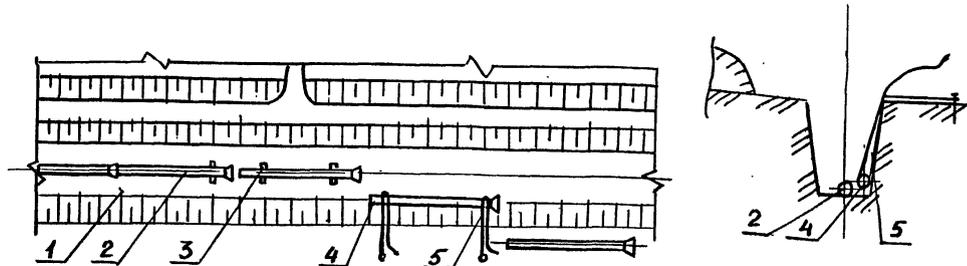
1 - траншея с откосами; 2 - трубопровод; 3 - труба; 4 - спускаемая в траншею труба; 5 - веревка; 6 - натяжное приспособление
