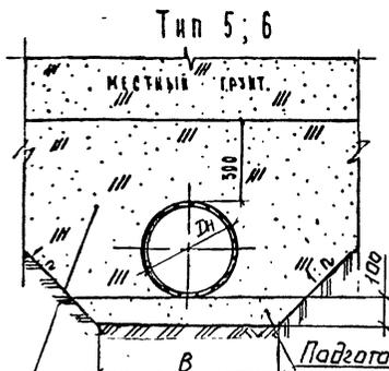
Засыпка грунтом с повышенной степенью уплотнения для типа 5 - местным до  $K_{сат} \geq 0,93$  для типа 6 - песчаным до  $K_{сат} \geq 0,91$
