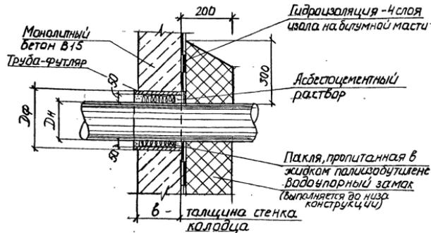
1. Водоупорный замок выполняется из глины или глинно-чужоженного перемятого суглинка, смешанного с битумными или дегтевыми материалами.
