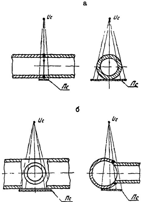
Рис. 5. Схема фронтального просвечивания через две стенки за одну установку источника излучения без его смещения относительно сварного шва:
