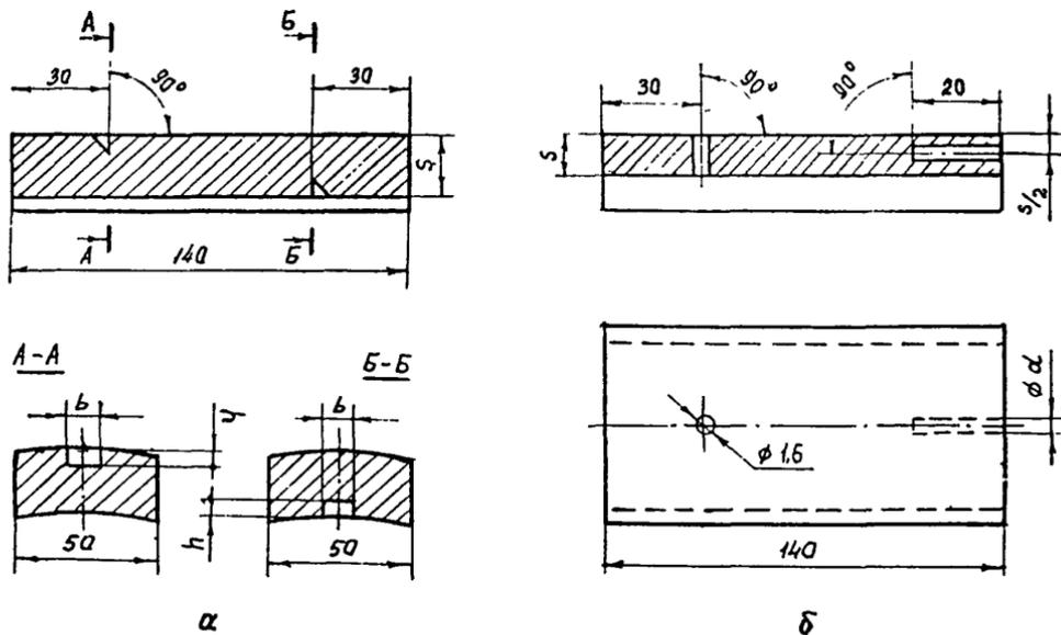
Рис.13. Стандартный образец предприятия для настройки ультразвуковых дефектоскопов:
