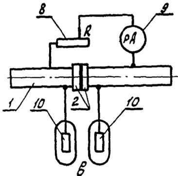
а-измерение сопротивления; б-определение эффективности действия; в-измерение и регулирование тока в шунтирующем резисторе; 1-трубопровод; 2-изолирующие фланцы; 3-контакт с трубопроводом; 4-многопредельный вольтметр; 5-установка катодной защиты; 6-точка дренажа; 7-неполяризующийся медно-сульфатный электрод сравнения; 8-регулирующий резистор; 9-амперметр; 10-токоотвод-протектор
