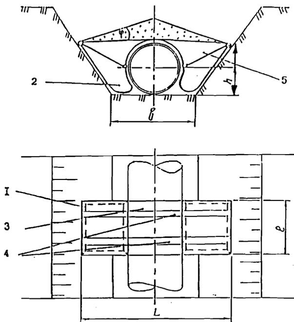
Рис. 3. Схема конструкции полимерно-контейнерного балластирующего устройства:
