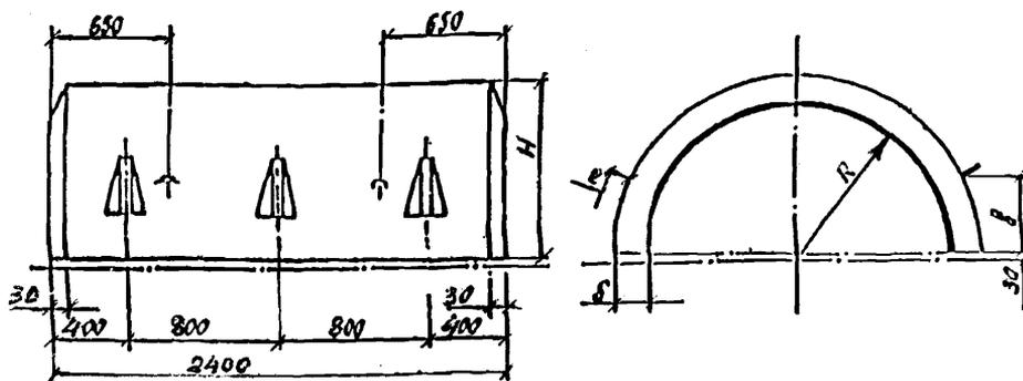
Рис. 2. Полукольцо утяжелителя типа 2-УТК
