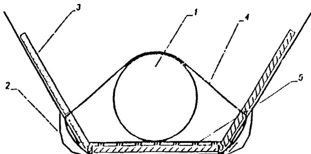
Рис. 8. Железобетонный утяжелитель типа УБГ:
