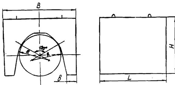
Рис. 7. Железобетонный утяжелитель типа 1-УБКМ
