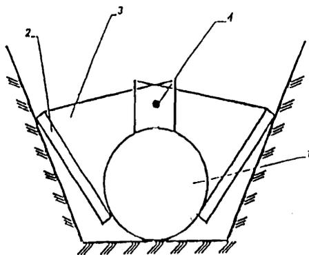
Рис. 9. Железобетонный утяжелитель типа УБТ:
