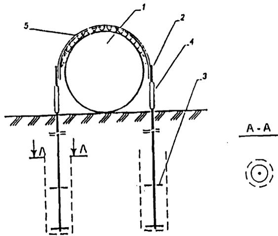
Рис. 12. Дискное вмораживаемое анкерное устройство ДАУ-02К:
