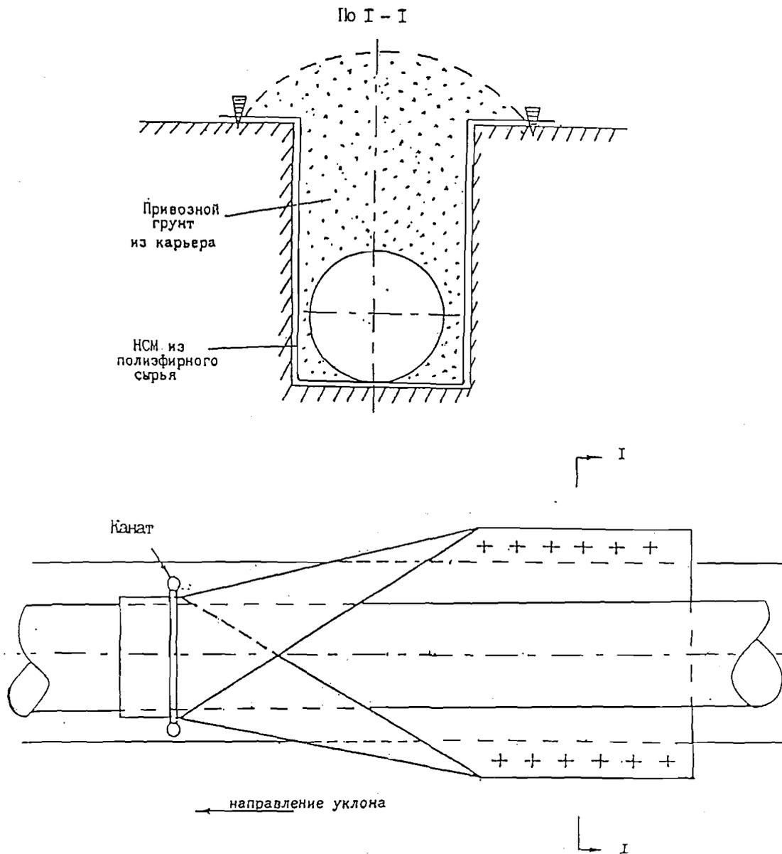
Рис. 19. Противозрозионная "ловушка" для грунта
