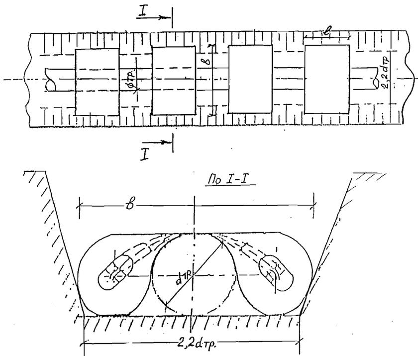
Рис. 4. Контейнерный утяжелитель типа КТ на газопроводе
