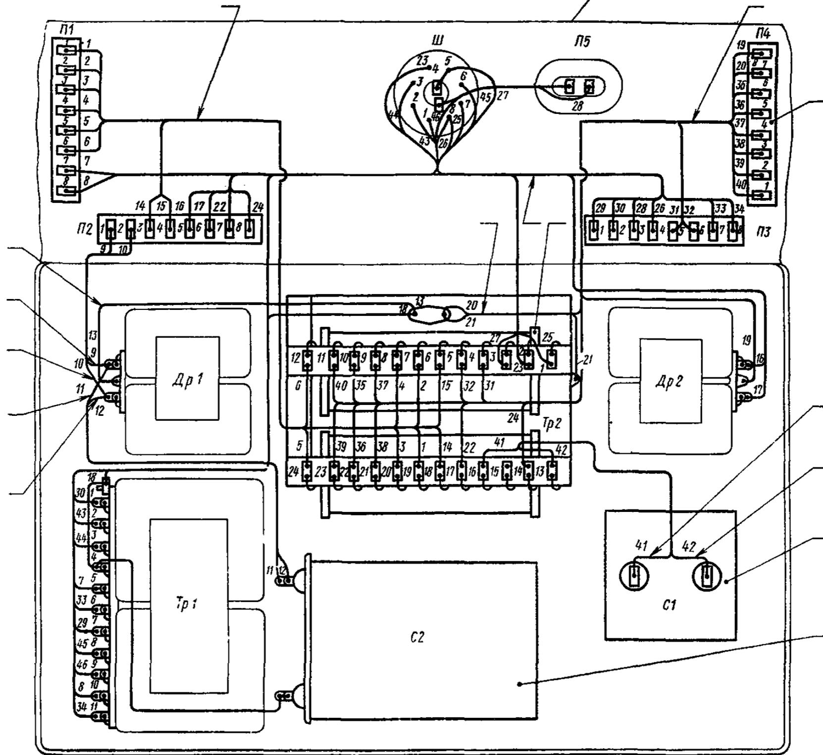
Допускается слияние линий, изображающих провода, кабели и жгуты, идущие в одном направлении, в одну линию.
