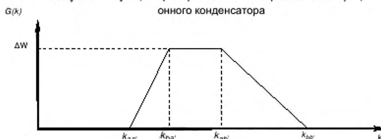
Рисунок 5 - Функция преобразования дифференциального аспирационного конденсатора
