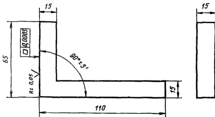
1. Специальный угольник следует изготавливать из углеродистой стали марки У10А по ГОСТ 1435—74.
