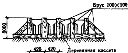
Рис.9. Правила складирования балок в деревянных кассетах.
