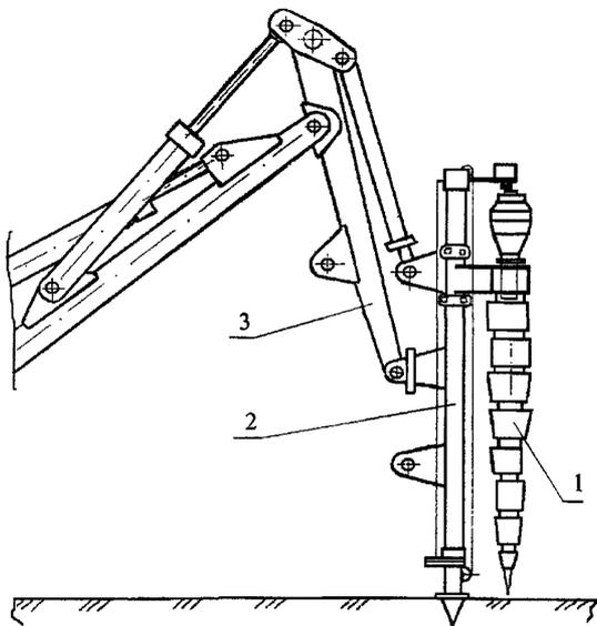
Рис. 5. Раскатчик, навешанный на рабочее оборудование экскаватора
