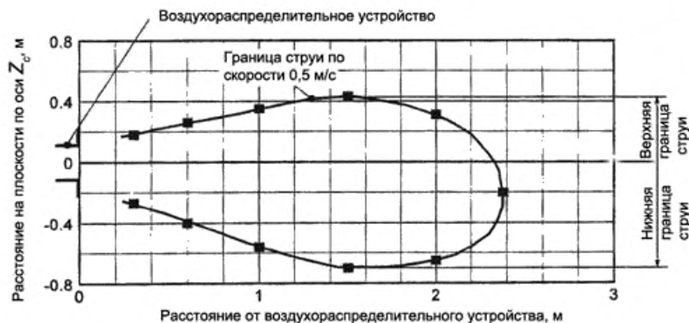
Рисунок А.6 - Характерный график для определения верхней и нижней границ струи (см. А.5)
