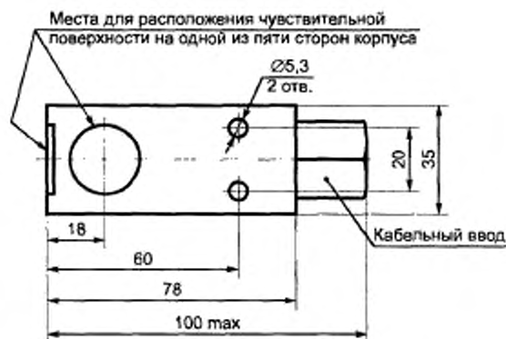
Рисунок А.1.2 (IC) – Габаритные размеры
