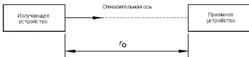
Рисунок 1а – Датчик типа Т. Излучающее устройство и приемное устройство – фотоэлектрический барьер
