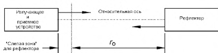
Рисунок 1б – Датчик типа R. Излучающее устройство, приемное устройство и рефлектор – фотоэлектрическое отражение
