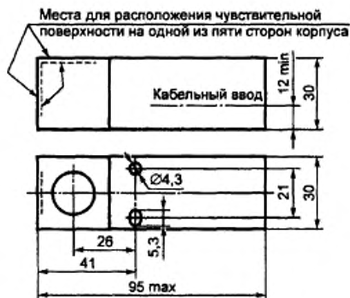
Рисунок А.1.3 (IC) – Габаритные размеры
