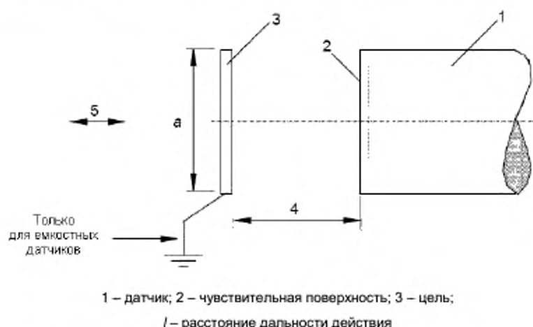
Рисунок 5 – Метод измерения расстояния дальности действия (8.3.2.1 и 8.4.1)
