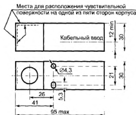
Рисунок А.1 (CC) а – Габаритные размеры датчика типа С30
