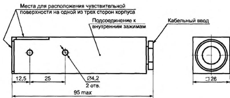
Рисунок A.1 (IC) – Габаритные размеры
