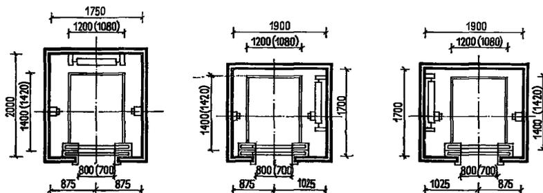
ГРУЗОПАССАЖИРСКИЕ ЛИФТЫ. ГРУЗОПОДЪЕМНОСТЬ 500 кг. СКОРОСТЬ 1,0 и 1,4 м/сек
