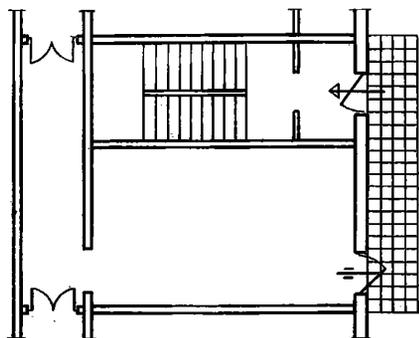
ЗАКРЫТАЯ ЛЕСТНИЦА С РАЗДЕЛЕНИЕМ ПО ВЫСОТЕ НА ПРОТИВОДЫМНЫЕ ОТСЕКИ С ПОДПОРОМ ВОЗДУХА
