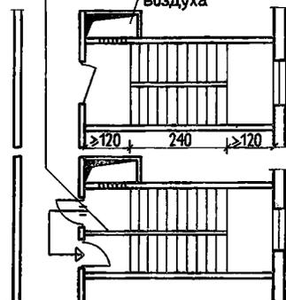
Лестницы проектируются, как правило, с естественным освещением. В стенах не задымляемых лестничных клеток, смежных с поэтажными вестибюлями, общими коридорами или галереями устройство открытых проемов не допускается. Допускается устройство световых проемов, заполненных стеклоблоками; при этом нижняя отметка светового проема должна быть не менее 120 см от уровня площадки или марша.
