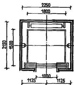
Для глухих железобетонных шахт лифтов могут быть применены сборные элементы (тюбинги высотой на этаж).
